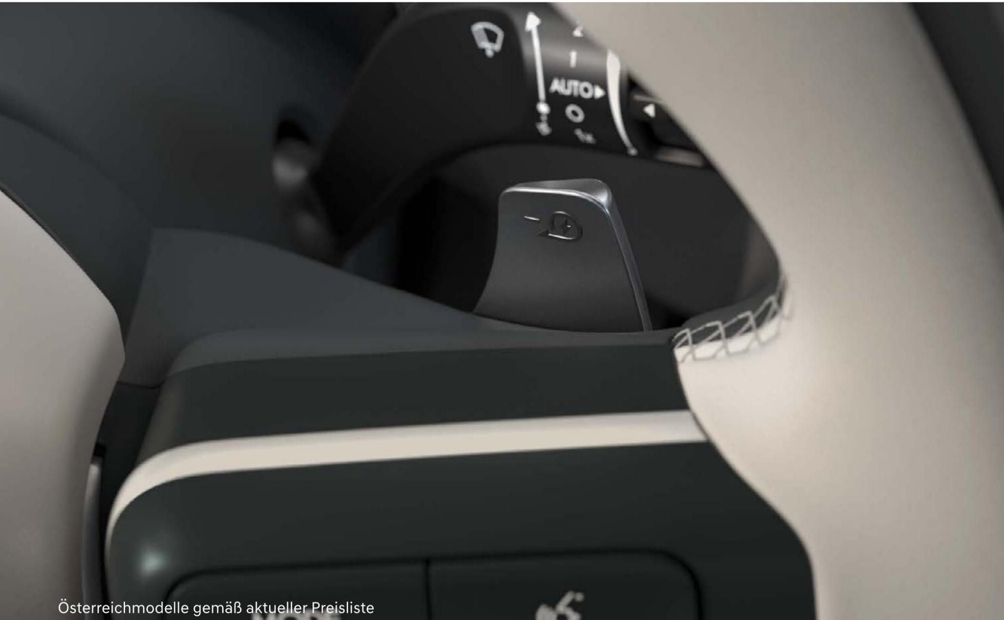
Das regenerative Bremssystem ermöglicht ein Laden der Hochvoltbatterie während der Fahrt, indem es den Elektromotor zum Abbremsen des Fahrzeugs nutzt. Mit den Schaltwippen am Lenkrad kann die Energiemenge, die das System zurückgewinnt und in die Batterie speichert, gesteuert werden. Je höher die Stufe, desto stärker bremst das Fahrzeug ab und lädt die Batterie, wenn die den Fuß vom Fahrpedal nehmen.
