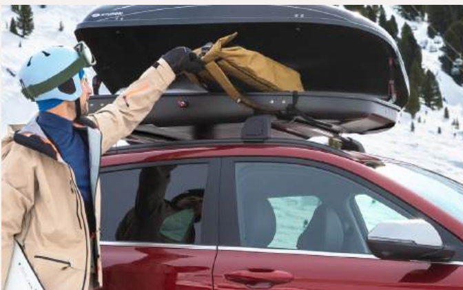
DACHBOX: 330 oder 390 Liter Fassungsvermögen, beidseitige Öffnung, sperrbar, Grundträger erforderlich
