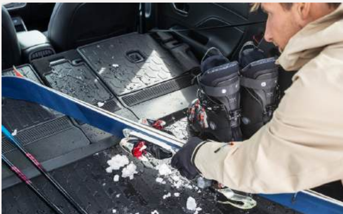
KOFFERRAUMWANNE: rutschfestes Material, erhöhte Kanten, perfekt auf jedes Modell angepasst
