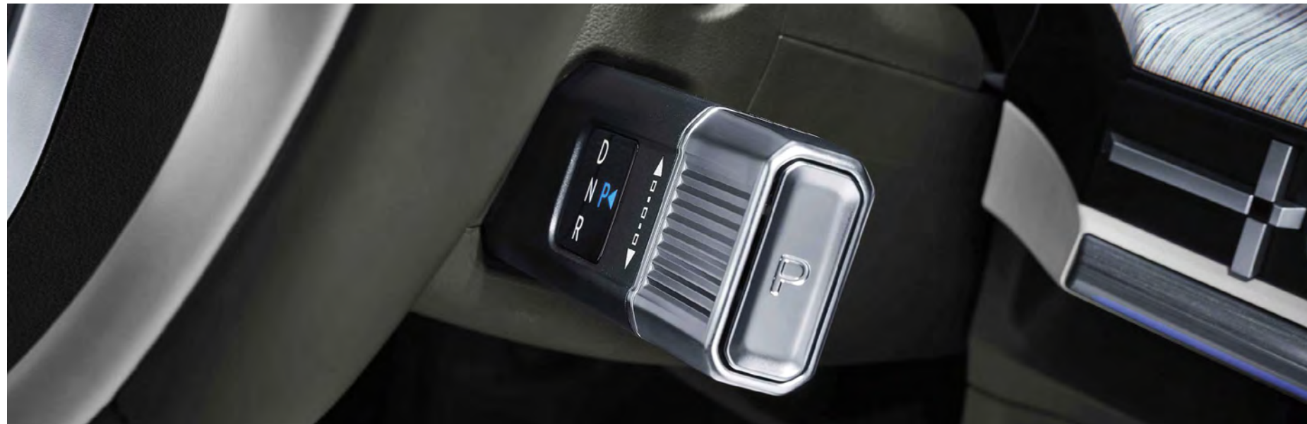
Shift by Wire - elektronische Steuerung der Gangwahl
