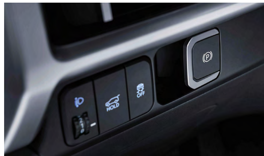
Elektrische Parkbremse mit Auto Hold Funktion (EPB)
