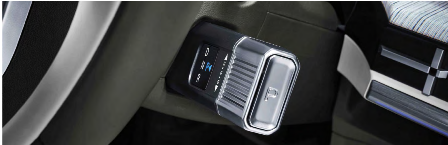
Shift by Wire - elektronische Steuerung der Gangwahl
