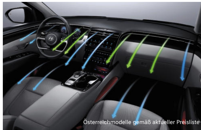
Multi-Air-Modus mit indirekten Lufteinlässen
