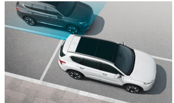
Toter-Winkel-Assistent (BCA) Der Tote-Winkel-Assistent nutzt zwei Radarsensoren im unteren hinteren Heckbereich, um Sie vor Verkehrsteilnehmern im toten Winkel zu warnen. Sobald Sie den Blinker in diese Richtung setzen, ertönt ein Warnsignal und das System bremst selektiv einzelne Räder, um den Wagen wieder in die Spur zurückzuholen.
