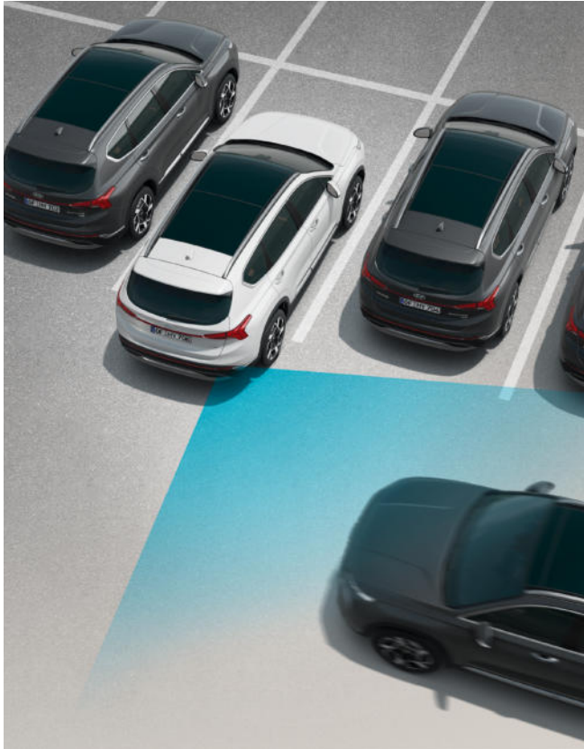
Querverkehr-Assistent hinten (RCCA) Beim Rückwärtsfahren aus Bereichen mit schlechter Sicht warnt Sie der Querverkehr-Assistent hinten vor seitlich heranfahrenden Fahrzeugen und bremst bei Bedarf automatisch ab.
