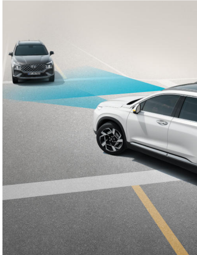
Notbremsassistent und City-Abbiegeassistent links (FCA, FCA-JT) Mit Kamera und Radarsensoren überwacht der Notbremsassistent den Verkehr, warnt Sie bei plötzlichem Abbremsen des vorausfahrenden Fahrzeugs und bremst automatisch ab. Dieses System erkennt auch Fußgänger und Radfahrer.
