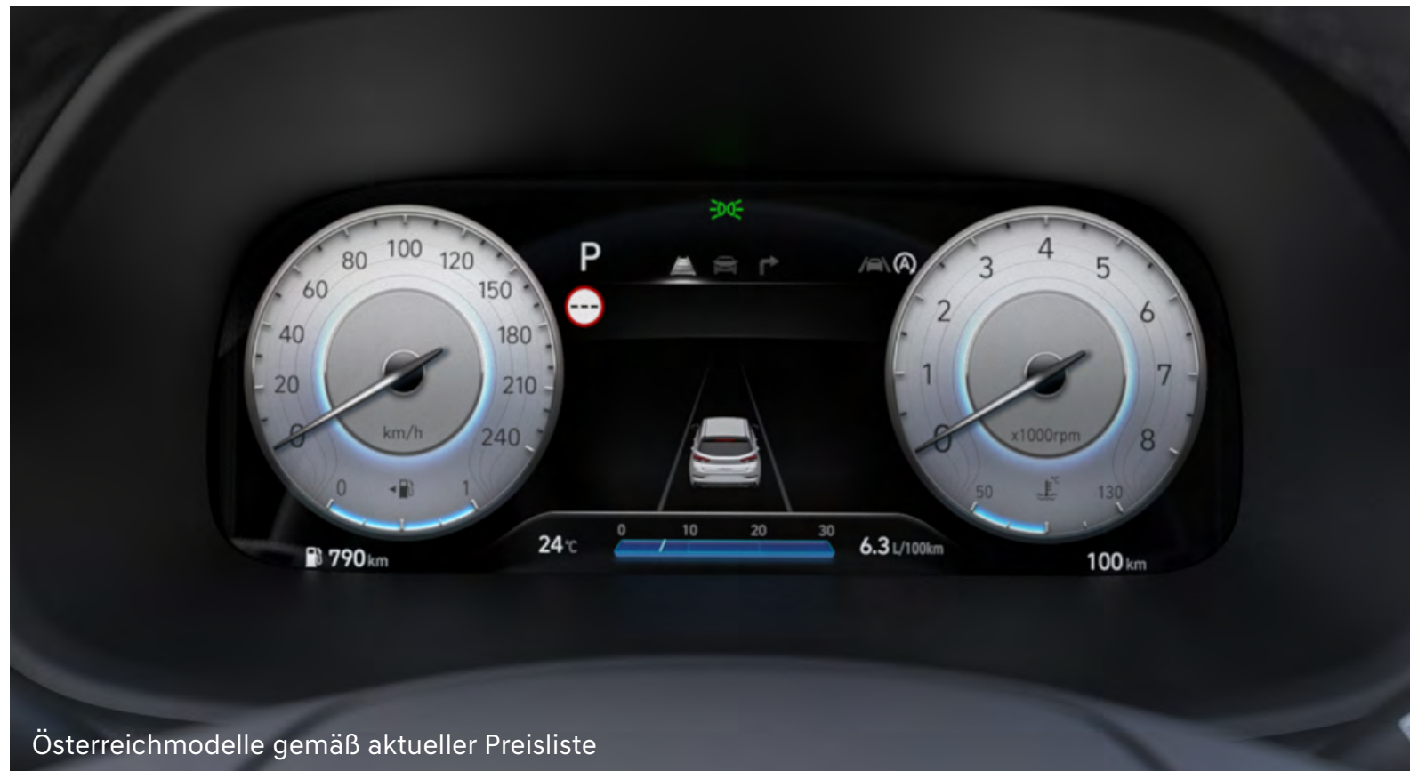
Digitale Armaturen mit 10,25 Zoll TFT-Bildschirm
