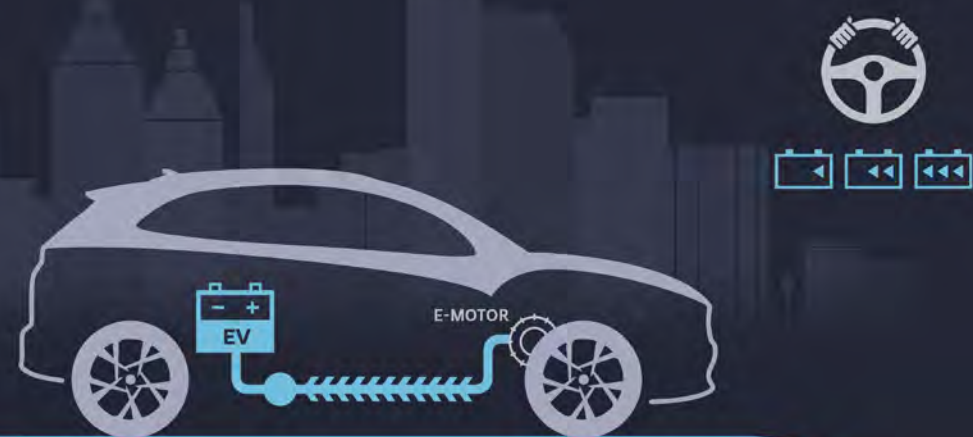
Selbst einstellbares regeneratives Bremsen
